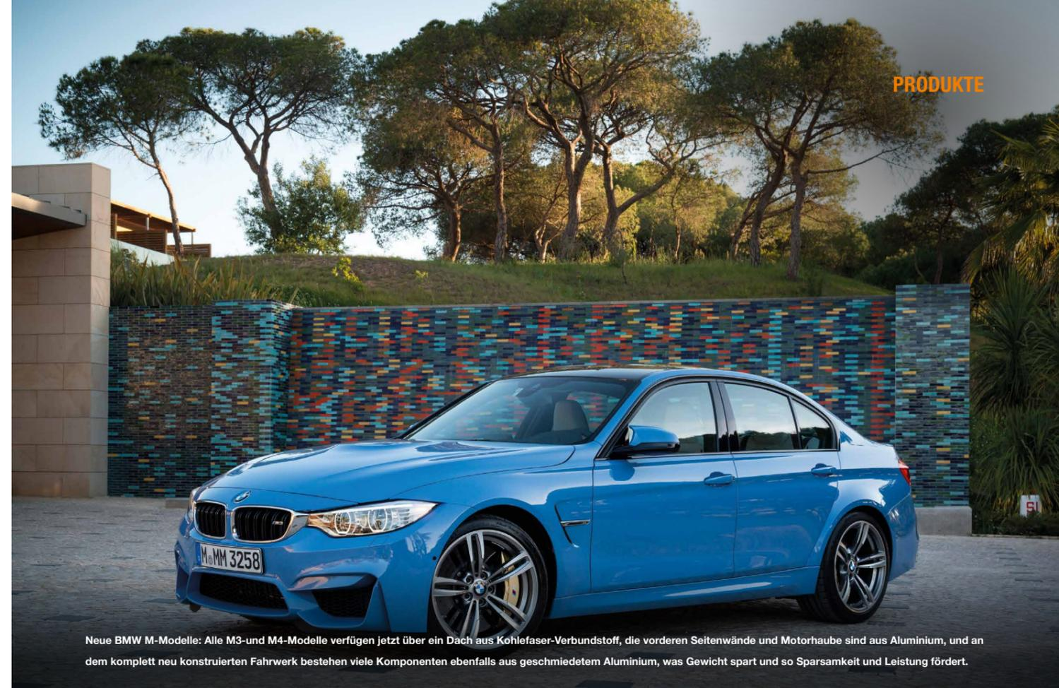
Neue BMW M-Modelle: Alle M3- und M4-Modelle verfügen jetzt über ein Dach aus Kohlefaser-Verbundstoff, die vorderen Seitenwände und Motorhaube sind aus Aluminium, und an dem komplett neu konstruierten Fahrwerk bestehen viele Komponenten ebenfalls aus geschmiedetem Aluminium, was Gewicht spart und so Sparsamkeit und Leistung fördert.
